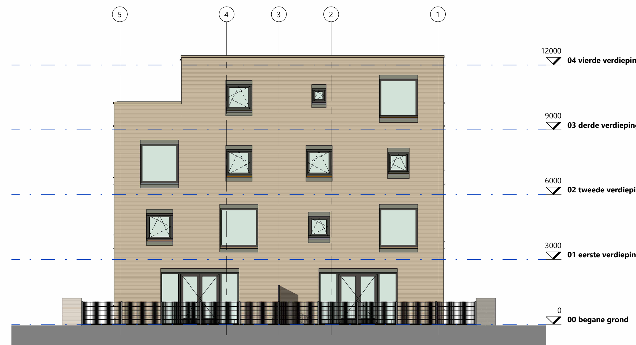
Gevelaanzicht noordgevel schaal 1:100
