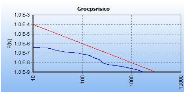
Figuur 15: De fN-curve voor deze kilometer leiding (leiding A-510 in de huidige situatie).
